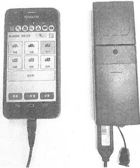
配送進捗管理システムのスマホとRFIDリーダーライター
